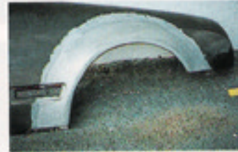
KLART. En stor del av hjulhuskanten sågas bort och ersätts med den breddade varianten. Därefter återstår tennspackling, slipning och lack.
