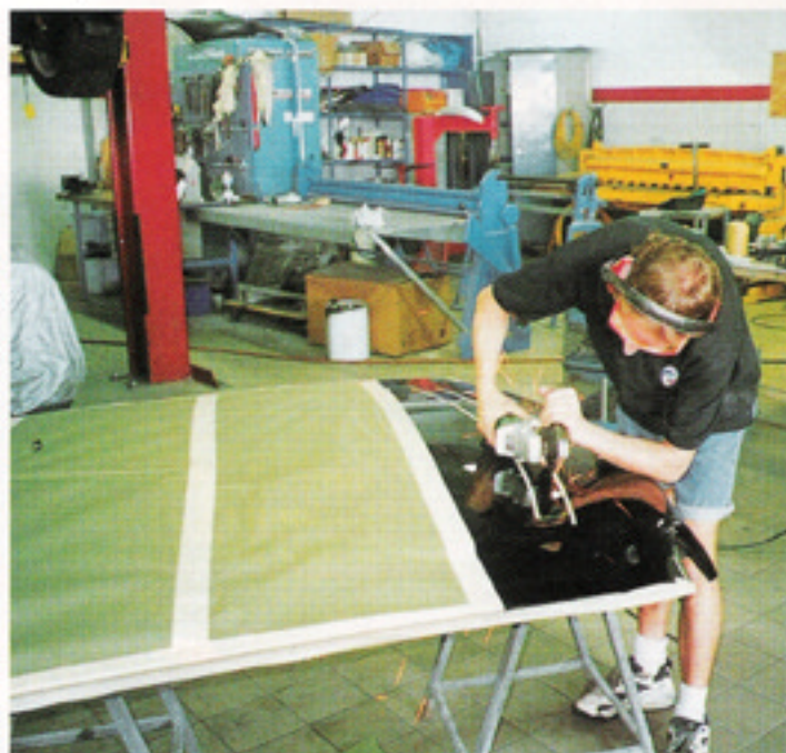
MER LUFT. För att få bättre kylning i motorrummet har Johan utvecklat ett luftutsläpp. En bit av plåten skärs loss och ersätts med motsvarande yta från ett torpedgaller.
