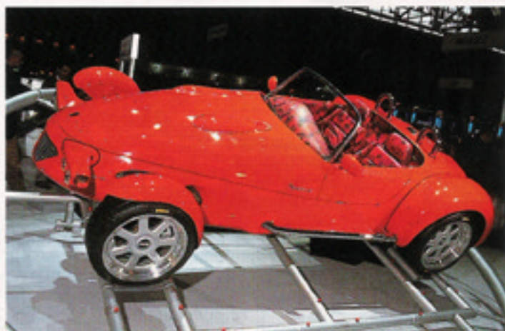
CONCEPT CAR. Redan 1995 fick Panoz Auto Development uppdraget att bygga en konceptbil åt schweiziska Rinspeed. Bilen baserades på en Panoz Roaster. Karossen bestod av aluminium. Motorn var en 5-liters V8 från Ford.
