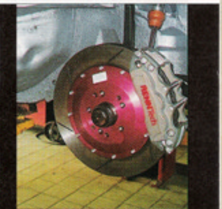
REJÄLT BETT. En trimmad V12-motor kräver rejäla bromsar. Fram monterades 14,5-tums skivor med 6-kolvs ok. Nedbromsning från 240 km/h till går på 7,4 sek.
