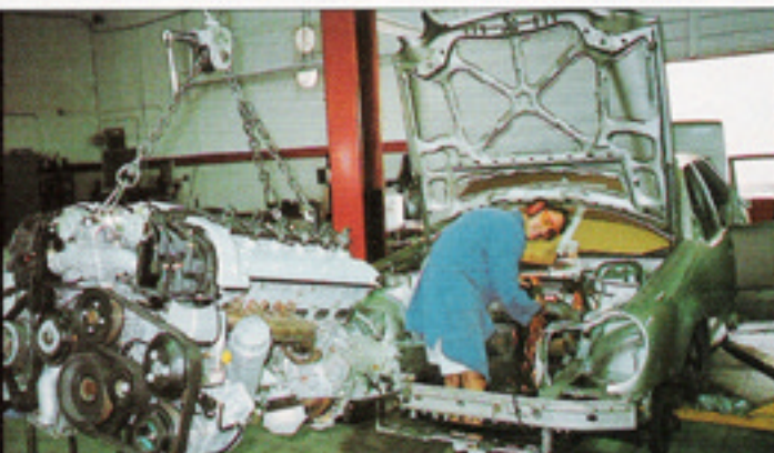
TRÅNGT. En Mercedes V12-motor kräver en hel del utrymme. I synnerhet om den ska ner i motorrummet i en E320-kaross. Johan är inte rädd för utmaningar. Här kapas det friskt.
