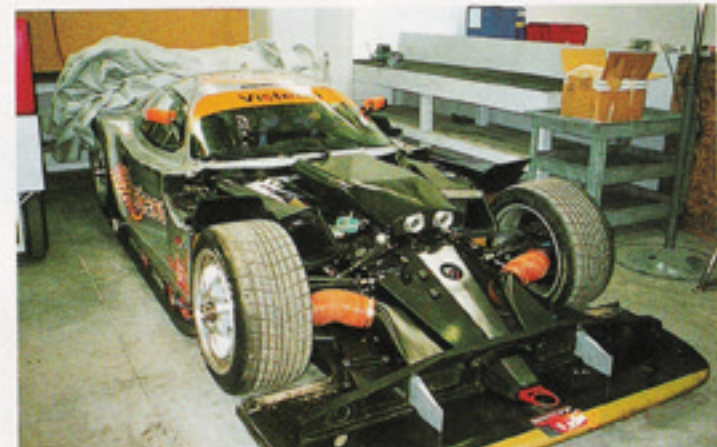
URSPRUNGET. Sportbilen som utvecklades till en racer. Man kan fortfarande skönja linjerna från gatmodellen i Panoz Esperante GTR. Men under skalet handlar det uteslutande om kolfiber. Drivkällan är en Roush-trimmad Ford V8 i aluminium som utvecklar 600 hk.
