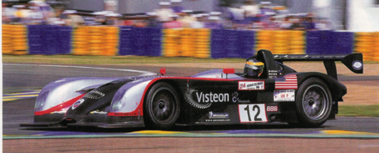
DAGSLÄGET. Panoz LMP-1 Roadster har kvar en liten del av den karaktäristiska fronten. I övrigt handlar det om en helt nyutvecklad modell. Anmärkningsvärt är att Panoz fortfarande satsar på frontmotorplacering. Under förkvalet till årets 24-timmars på Le Mans noterade LMP-1 Roadstern näst snabbaste tid efter Toyota!
